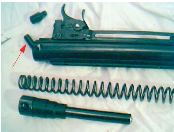
Фото 15. Детали: головка винта, боковой поперечный штифт (показан стрелкой), пружина, поршень.
