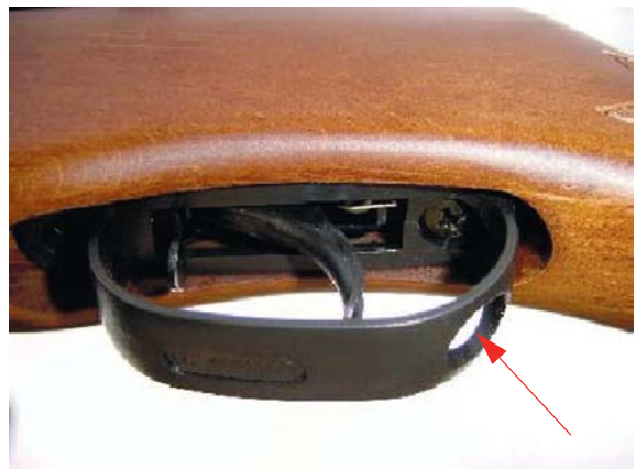
Фото 12. Отверстие в спусковой скобе (показано стрелкой).
