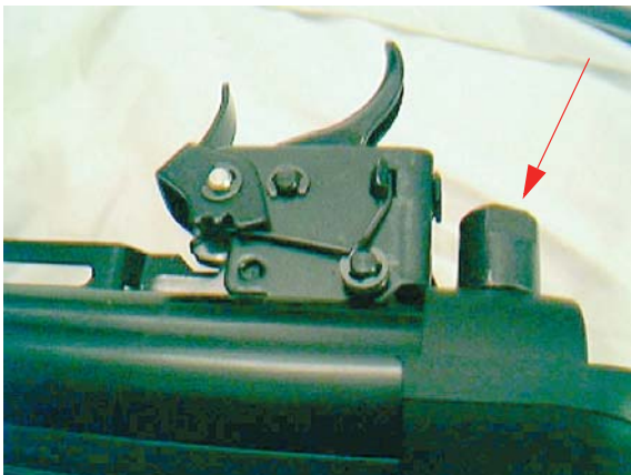
Фото 14. Головка винта УСМ под ключ 12 (показана красной стрелкой).
