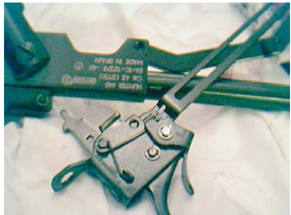
Фото 16. УСМ - нет ни одной фрезерованной детали.
