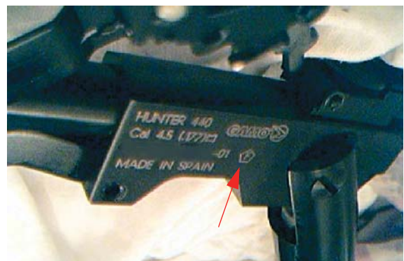
Фото 9. Ослабленные винтовки имеют клеймо в виде буквы "F" в пятиугольнике. Клеймо отмечено красной стрелкой.
