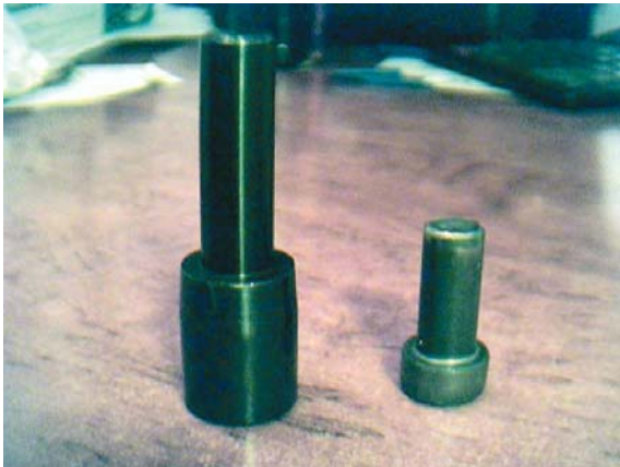
Фото 1. На фото для сравнения показаны утяжелители поршней винтовок Хантер 1250 (слева) и 220/440/880/890 (справа).
