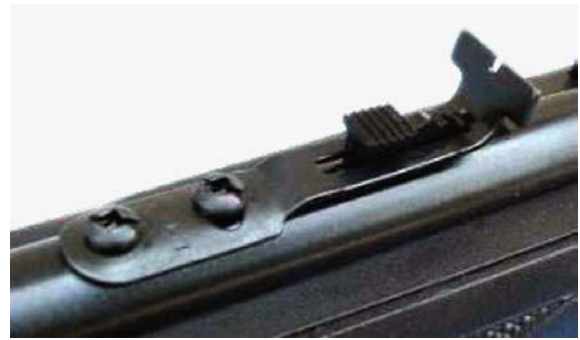
Фото 5. ... и регулируемого в двух плоскостях целика. Регулировка целика по высоте довольно грубая: всего пять позиций.
