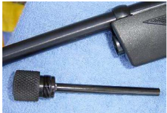
Фото 7. Рифлённый поджимной винт вынут полностью
