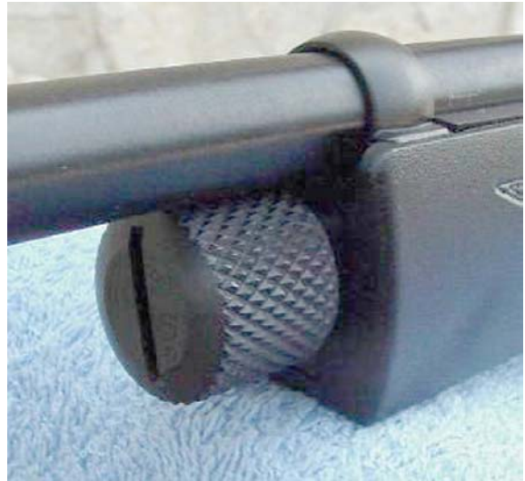
Фото 6. Сначала отвинчиваем рифленый поджимной винт, расположенный в самом начале цевья под стволom.
