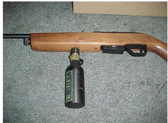
Фото 14. Автор этой конструкции Crosman 1077 заявил начальную скорость пули 245 м/с, но способ достижения такой скорости не описал
