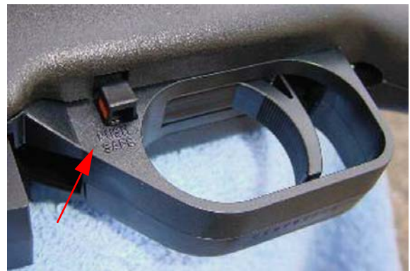
Фото 11. С левой стороны спусковой скобы - головка предохранителя с красными рисками по бокам и надпись "PUSH SAFE" (показано красной стрелкой)
