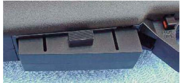
Фото 10. Магазин вставлен в винтовку прямолинейно снизу до щелчка
