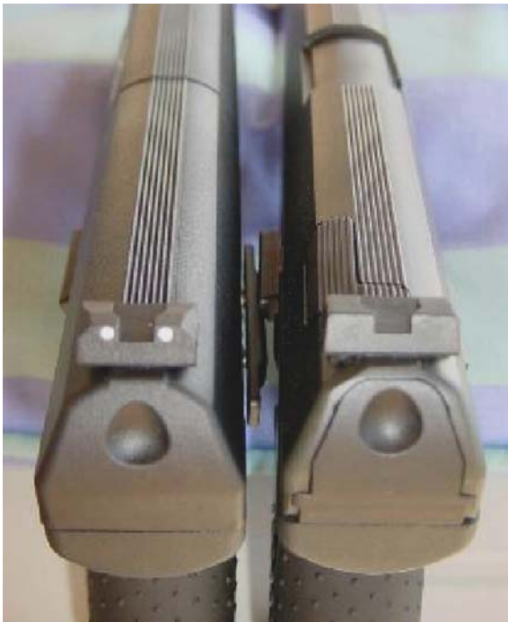
Фото 5. Прорезь целика и ширина мушки у Umarex CPS (слева) шире, чем на Walther CP-99.
