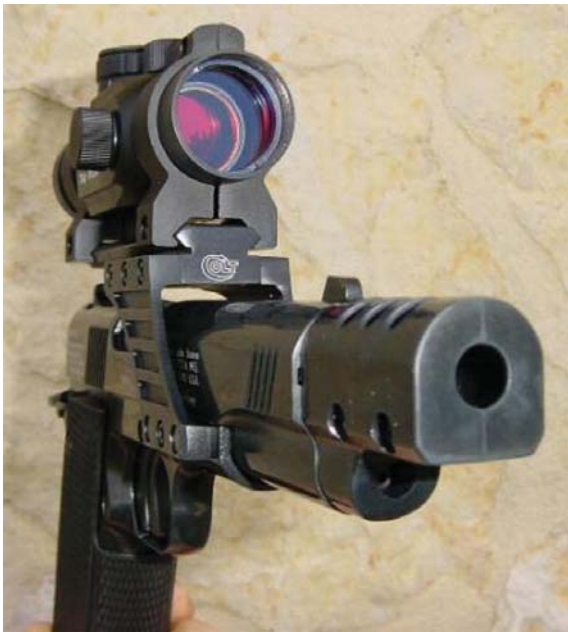
Фото 6. Все вышеизложенные версии UMAREX COLT 1911A1 Government Model могут встречаться в комплектации GOLD CUP TROPHY MATCH – матчевые модели. Они имеют компенсатор, являющийся продолжением кожуха-затвора и крепящийся винтом под стволом. Надульник - компенсатор является чисто декоративной деталью.
