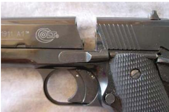
Фото 8. Нажимаем на затворную задержку и передняя часть кожуха-затвора сдвигается вперед, открывая щель для вставления барабана-клипа.
